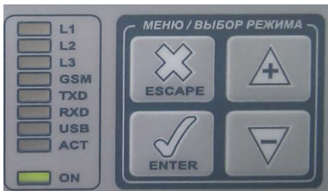
Рисунок 5. Кнопки управления пультовым прибором
