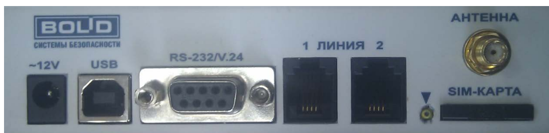
Рисунок 1. Задняя крышка «УОП-3 GSM» с разъемами
