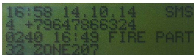
Рисунок 8. Отображение тревожного сообщения сообщения в формате SMS «Эгида-2» по GSM
