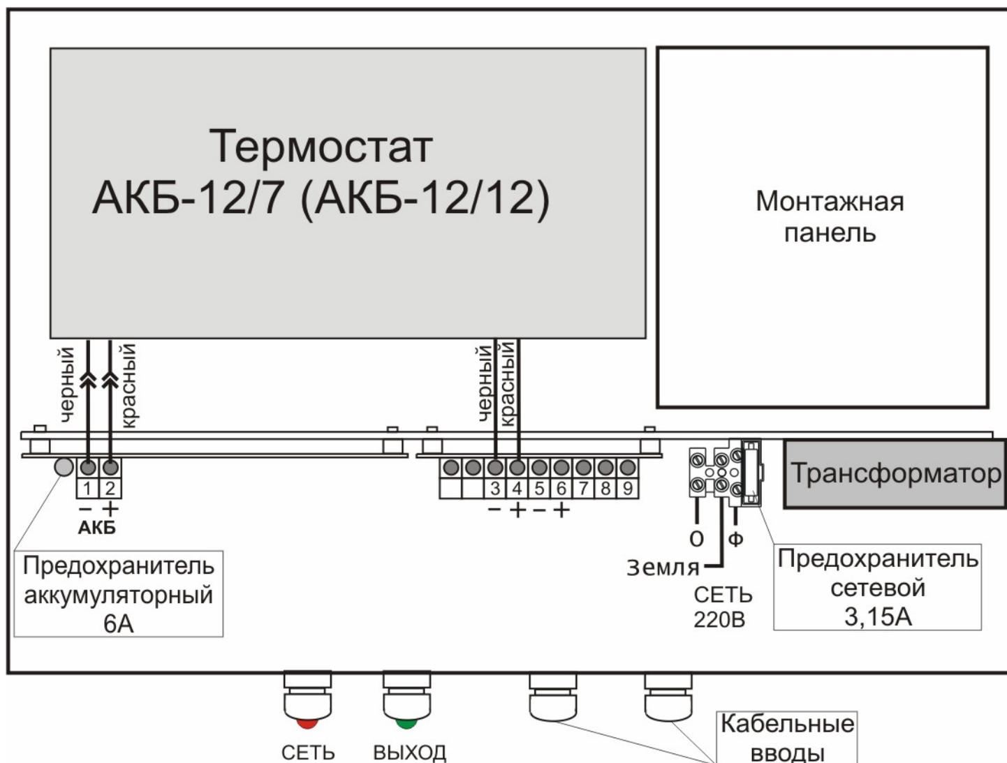
Рис.1 **Стандартный** вариант подключения термостата.
