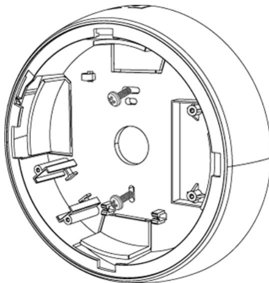
Подключите громкоговоритель к подведенному кабелю трансляционной линии, а затем соедините обе части устройства, совместив установочные метки на корпусе и повернув лицевую часть по часовой стрелке до щелчка фиксатора.
